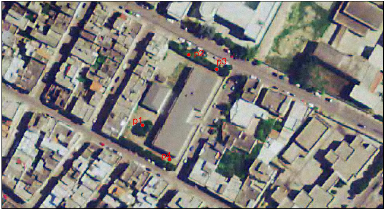
Fig. 6-Ubicazione delle prove penetrometriche
